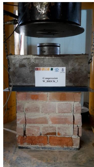
Fig. 69 – Parede de 20x40x40 depois do ensaio
