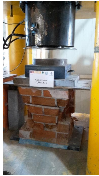
Fig. 67 – Parede de 40x40x50 depois do ensaio
