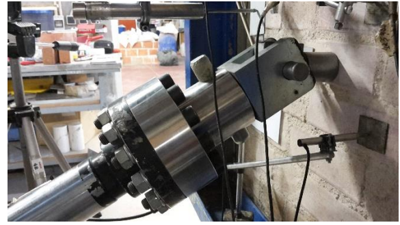
Fig. 79 – Rótula utilizada no pull out inclinado das ancoragens mecânicas das paredes de pedra e tijolo
