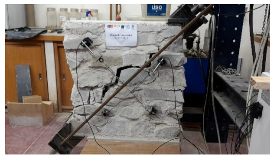
Fig. 59 – Alvenaria de pedra após o ensaio
