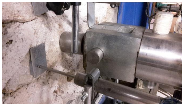
Fig. 74 – Rótula utilizada no pull out horizontal das ancoragens química e com grout das paredes de pedra
