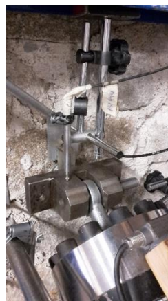
Fig. 77 – Rótula utilizada no pull out inclinado das ancoragens química e com grout das paredes de pedra
