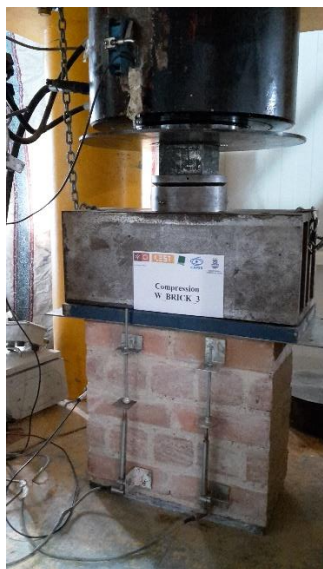
Fig. 68 – Parede de 20x40x40 antes do ensaio
