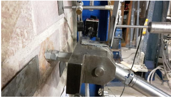
Fig. 78 – Rótula utilizada no pull out inclinado das ancoragens química e com grout das paredes de tijolo
