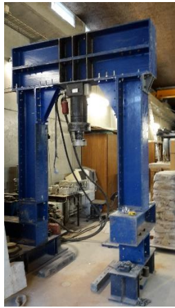
Fig. 37 – Setup do pórtico E1 para realização do furo e colocação da ancoragem
