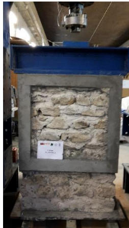
Fig. 38 – Posicionamento da parede no pórtico do equipamento E1
