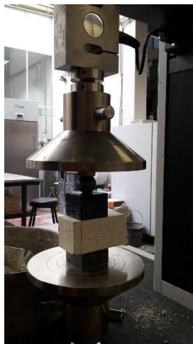
Fig. 92 – Ensaio de compressão em prisma
