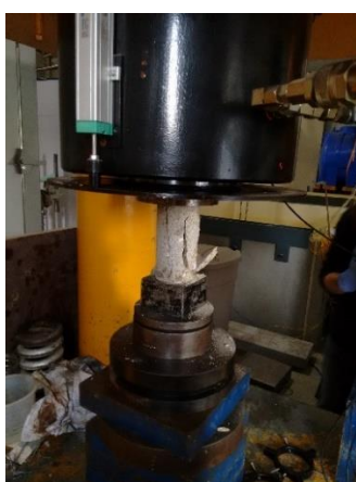
Fig. 18 – Ensaio de compressão
