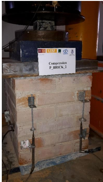
Fig. 66 – Parede de 40x40x50 antes do ensaio
