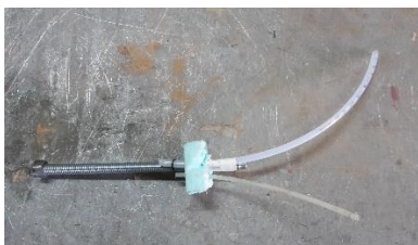
Fig. 49 – Conector com anilha soldada e tubos para expulsão do grout (certeza do preenchimento até o fundo) e saída do ar
