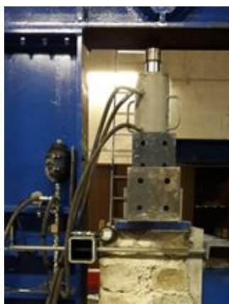
Fig. 70 – Macaco e relógio medidor
