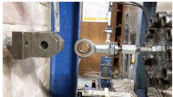
Fig. 75 – Rótula utilizada no pull out horizontal das ancoragens química e com grout das paredes de tijolo
