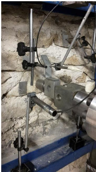
Fig. 80 – Colocação dos LVDTs
