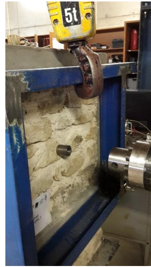
Fig. 85 – Colocação de nova parede e estrutura de fixação
