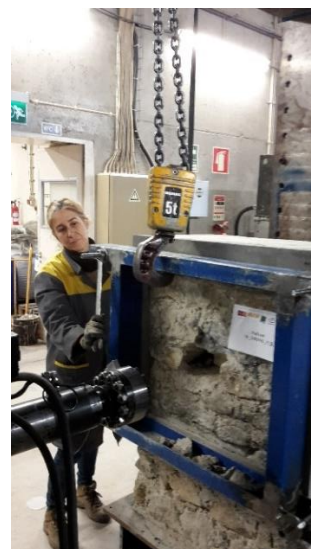
Fig. 83 – Remoção do conjunto de fixação
